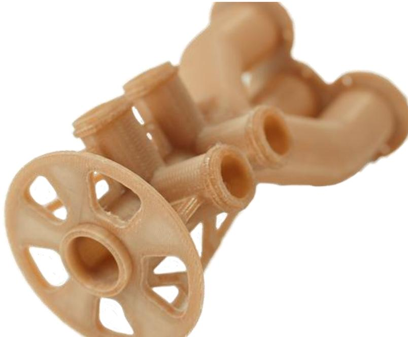
Il Victrex AM™ 200 è un materiale termoplastico FDM di poliarileterchetone (LMPAEK) a basso punto di fusione. Progettato specificamente per la fabbricazione additiva, offre i vantaggi di un materiale poliarileterchetone (PAEK), capace al contempo di fare fronte alle sfide legate alla stampa 3D di questa famiglia di polimeri che comprende PEEK e PEKK.
